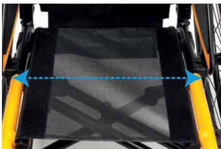
Sur votre **Trigo**, la largeur d'assise est obtenue en retirant le coussin d'assise et en mesurant entre les tubes extérieurs du châssis.
