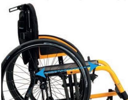
Sur votre **Trigo**, la profondeur d'assise est obtenue en retirant le coussin d'assise et en mesurant la distance entre le tube du dossier et le bord avant de la toile.
