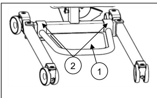
La plaque repose-pieds ① peut-être montée avec les crochets ② sur le châssis du lève-personne ou détachée de ce dernier.
