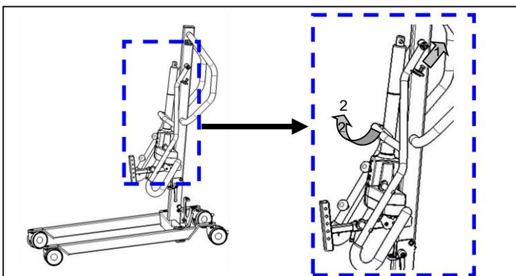
4. Retirez le bras de levage de la partie supérieur de la tringle (2). Tirez pour cela sur le dispositif de fixation (1).
