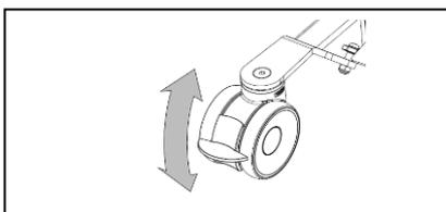
1. Bloquez les deux roues à l'arrière du châssis en appuyant légèrement de la pointe du pied sur la patte du frein des roues en l'abaissement jusqu'à ce qu'elles soient bloquées. Pour desserrer les freins, soulever de la pointe du pied sur la pédale de frein vers le haut jusqu'à ce que les roues soient libérées.
