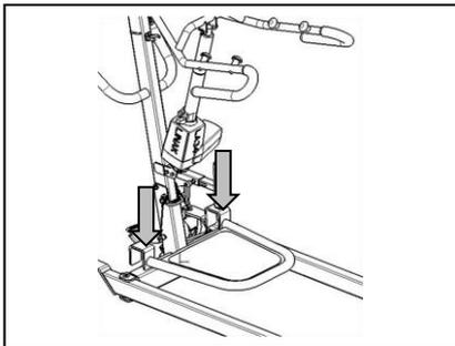
7. Fixez la plaque repose-pieds avec les crochets sur le châssis du lève-personne.
