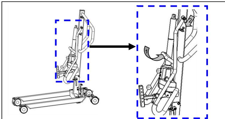
6. Réglez le bras de levage en position inférieure (1). Introduisez le dispositif de fixation en haut de la tringle dans l'orifice du bras de levage (2).
