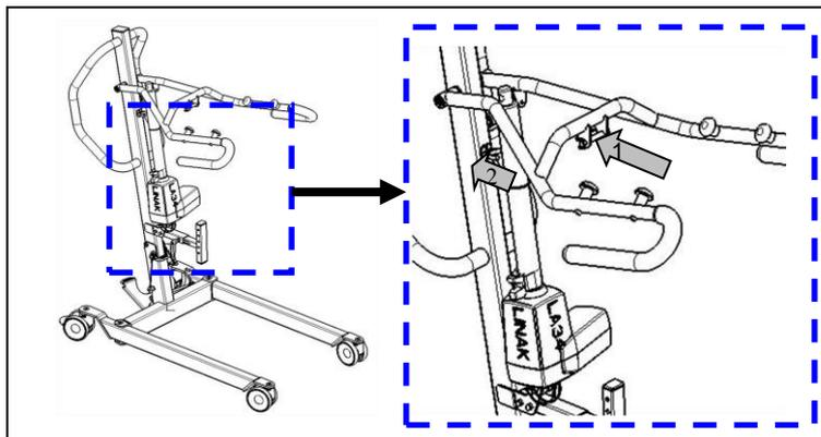
4. Détachez l'actionneur (moteur) du bras de levage en retirant la broche de verrouillage (1).
