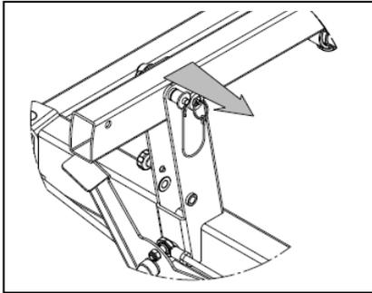
1. Retirez l'axe de fixation (arbre de transmission) en bas du mât en appuyant légèrement sur le bouton sur la tête de l'axe. Vous pouvez alors retirer facilement l'axe de fixation.
