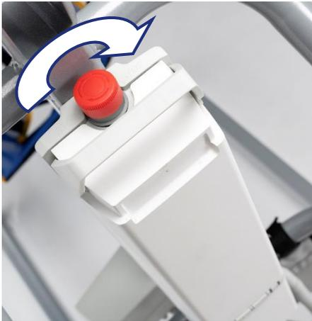
En cas d'urgence ainsi que lors du montage et du démontage, vous pouvez activer l'arrêt d'urgence en actionnant le bouton rouge du boîtier de commande.
