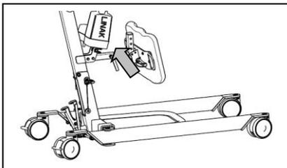
8. Fixez le repose-jambes au moyen de la broche de verrouillage. Réglez le repose-jambes sur la hauteur et la profondeur désirées.
