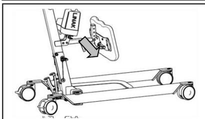
2. Retirez le repose-jambes en détachant la broche de verrouillage.
