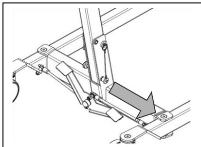
7. Retirez l'axe de fixation (arbre de transmission) en bas du mât en appuyant légèrement sur le bouton sur la tête de l'axe. Vous pouvez alors retirer facilement l'axe de fixation.
