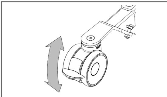
Bloquez les deux roues à l'arrière du châssis en appuyant légèrement de la pointe du pied sur la patte du frein des roues en l'enfonçant vers le bas jusqu'à ce qu'elles soient bloquées. Pour desserrer les freins, appuyez de la pointe du pied sur la pédale de frein vers le haut jusqu'à ce que les roues soient libérées.
