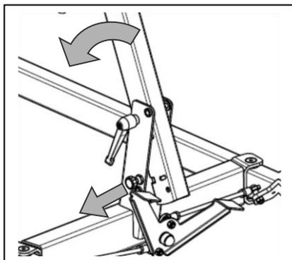
8. **⚠ AVERTISSEMENT: Risque de blessure – Lorsque le mât est déverrouillé, d'importantes forces de pesanteur peuvent s'exercer du fait du poids du mât.**
