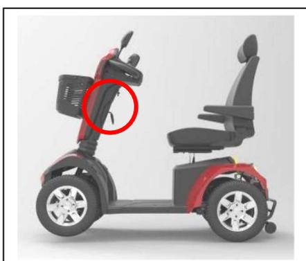
Le boîtier de direction peut être réglé dans de nombreuses positions (en continu) pour s'adapter à chaque conducteur.
