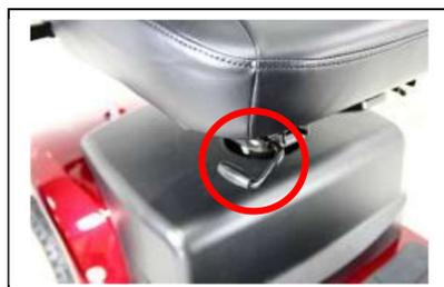
1. Tirez le levier de réglage de la profondeur de siège vers le haut.
