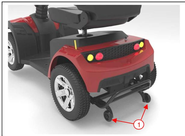
Un anti-basculement (1) est fixé à l'arrière du châssis du scooter. Il n'est pas possible de le retirer. L'anti-basculement est là pour votre sécurité. Il empêche le scooter de basculer vers l'arrière lorsque vous franchissez de petits obstacles qui ne dépassent PAS la hauteur maximale indiquée au §6.
