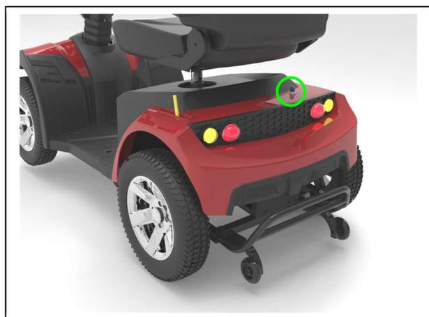
Pour protéger le moteur contre la surcharge, votre scooter est équipé d'un mécanisme de sécurité thermique à l'arrière. Le fusible thermique coupe automatiquement le moteur pour éviter la surchauffe et donc l'usure rapide ou les pannes. Vous pouvez accéder au dispositif de sécurité thermique par une ouverture au dos du couvercle synthétique.
