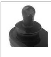
Durch Bewegen des Joysticks in eine Richtung fährt der Elektro-Rollstuhl in die vorgegebene Richtung. Der Betrag der Joystick-Bewegung bestimmt die Geschwindigkeit, mit der sich der Elektro-Rollstuhl in diese Richtung bewegt.
