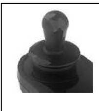
Uw elektrische rolstoel rijdt in de richting waarnaar U Uw joystick beweegt. De hoeveelheid van de beweging van de joystick is bepalend voor de snelheid waarmee Uw elektrische rolstoel in die richting gaat.
