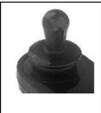
El joystick sirve para dirigir la silla de ruedas eléctrica en la dirección de su movimiento. La cantidad de movimiento del joystick determinará la velocidad con que la silla eléctrica se moverá en dicha dirección.
