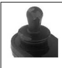
Przesuwanie joysticka spowoduje skierowanie elektrycznego wózka inwalidzkiego w danym kierunku. Stopień wychylenia joysticka określa prędkość, z jaką wózek będzie się przemieszczał w danym kierunku.
