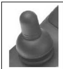
Votre fauteuil roulant électrique roule dans la direction vers laquelle vous orientez la manette. L'ampleur du mouvement de la manette détermine la vitesse à laquelle le fauteuil roulant électrique se déplace dans cette direction.
