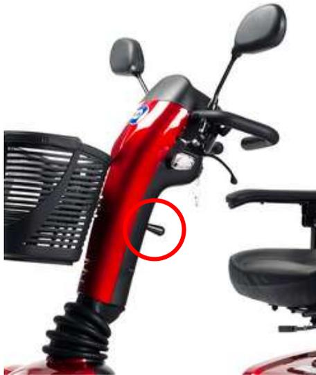
Le boîtier de direction peut être réglé dans de nombreuses positions (en continu) pour s'adapter à chaque conducteur.
