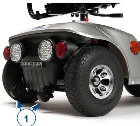
Un anti-basculement (1) est fixé à l'arrière du châssis du scooter. Il n'est pas possible de le retirer. L'anti-basculement est là pour votre sécurité. Il empêche le scooter de basculer vers l'arrière lorsque vous franchissez de petits obstacles qui ne dépassent PAS la hauteur maximale indiquée au §6.
