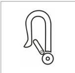
9. Vérifiez que le raccord d'extrémité de la fixation est compatible avec les points d'attache du fauteuil roulant.
