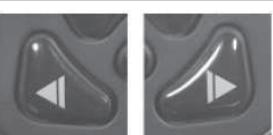
Om aan te geven om naar links of rechts af te draaien, drukt U op de linkse of rechtse richtingaanwijzer knop zoals vereist. De groene LED onder de geactiveerde knop van de richtingaanwijzer knippert. Druk opnieuw op de knop om de aanwijzer uit te schakelen.
