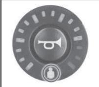
Al activar el control del acompañante, el LED ACU se encenderá y permanecerá encendido hasta que el acompañante deje el mando.
