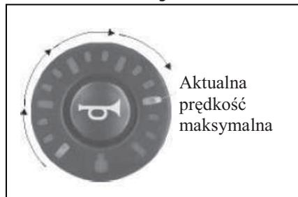
Wskaźnik prędkości służy do wskazywania prędkości jazdy wózka inwalidzkiego względem maksymalnej możliwej prędkości. Prawa skrajna dioda LED oznacza aktualną maksymalną prędkość, którą można ustawić za pomocą przycisku Zwiększ (Zmniejsz) prędkość. Za pomocą joysticka, w miarę wzrostu prędkości wózka, diody LED będą się kolejno zapalać aż do osiągnięcia maksymalnej prędkości (jak pokazano na rysunku).
