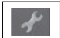
L'indicatore luminoso LED per la manutenzione segnala i codici di errore. Per un elenco dei codici di errore, vedere il paragrafo 3.
