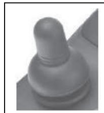
Beweeg de joystick en rijdt de elektrische rolstoel in die richting. De hoeveelheid beweging van de joystick bepaalt de snelheid waarin de rolstoel in die richting zal bewegen.
