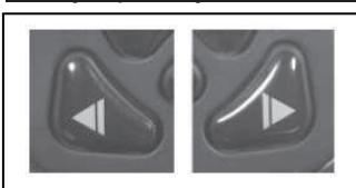
Aby poinformować o skręcie w lewo lub w prawo, naciśnij przycisk lewego lub prawego kierunkowskazu. Zielona dioda pod naciśniętym przyciskiem kierunkowskazu będzie migać. Naciśnij ponownie przycisk kierunkowskazu, aby wyłączyć kierunkowskaz.
