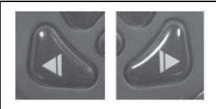
Zum Anzeigen eines Fahrtrichtungswechsels nach links oder rechts drücken Sie die linke oder rechte Fahrrichtungsanzeige-Taste. Die grüne LED unter der aktivierte Fahrrichtungsanzeige-Taste blinkt. Drücken Sie die Taste erneut, um die Fahrrichtungsanzeige wieder auszuschalten.
