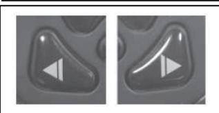
Para indicar un giro a izquierda o derecha, pulse el botón del intermitente izquierdo o derecho, según corresponda. El LED verde debajo del botón del intermitente que se haya activado parpadeará. Pulse de nuevo el botón para apagar el indicador.
