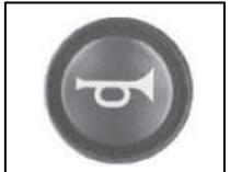
Drücken Sie die Taste mit dem Signalhorn. Der Signalton ertönt so lange, wie die Taste gedrückt wird.
