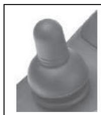
Przesuwanie joysticka spowoduje skierowanie elektrycznego wózka inwalidzkiego w danym kierunku. Stopień wychylenia joysticka określa prędkość, z jaką wózek będzie się przemieszczał w danym kierunku.
