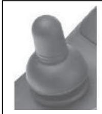
La direzione del movimento del joystick determinerà la direzione di marcia della carrozzina elettrica. La quantità del movimento del joystick determinerà la velocità dello spostamento della carrozzina nella direzione scelta.
