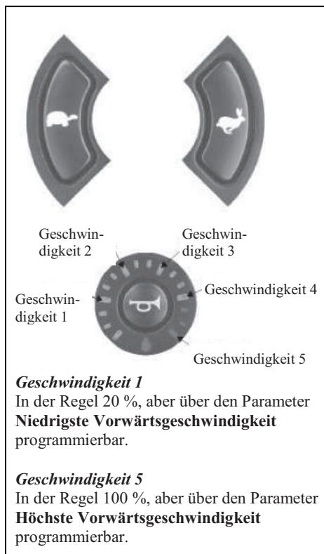
Der Benutzer kann die Höchstgeschwindigkeit des Elektro-Rollstuhls an seine Präferenzen und an die Umgebung anpassen. Die aktuell ausgewählte Höchstgeschwindigkeit wird in der Geschwindigkeitsanzeige angezeigt. Sie kann mit den Tasten zum Erhöhen der Geschwindigkeit (Hase) und Verringern der Geschwindigkeit (Schildkröte) eingestellt werden.
