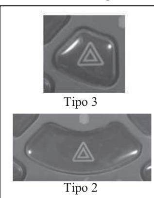
Para encender las luces de emergencia, pulse el botón de emergencia. Los dos LED verdes situados debajo de los botones de los intermitentes izquierdo y derecho parpadearán simultáneamente. Pulse de nuevo el botón de emergencia para detener la luz de emergencia.
