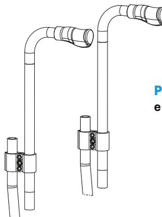
**PH 05** Poignées de poussée ajustables en hauteur (derrière les tubes de dossier)
